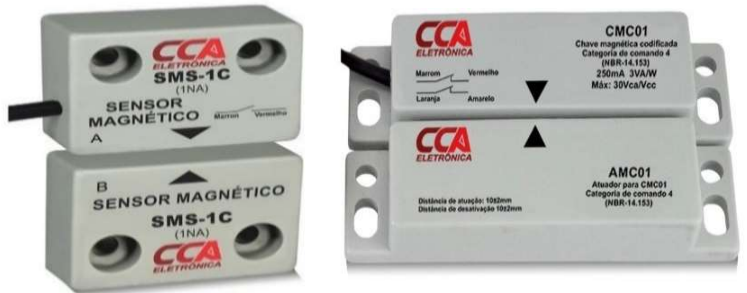
Código CIMG Descritivo SM10001 Sensor Magnético de Proximidade. Emissor + Receptor - Contato: 1NA SMP0001 Chave Magnética Codificada CMC01 (sensor+atuador) Contatos 2NF. Categoria comando 4
