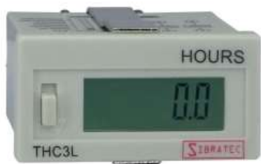
Código CIMG Descritivo HDT0001 Horímetro Digital THC3L - Gatilho Contato Seco - Escala 99999,9 Horas - Tamanho 21,8 x 44,5mm
